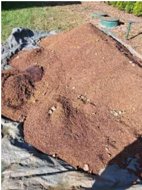
Zużyte złożo SUW Pilica, SUW Gośńiewice
